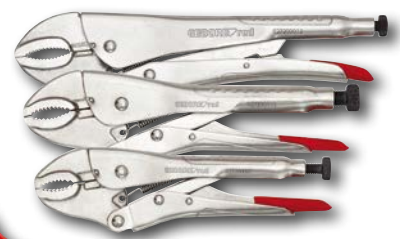
12 Gripzangen-Satz, 3-tlg. Zum Klemmen und Spannen von Profil-, Rund- und Flachmaterial. Längsverzähnte Greifflächen, mit Einstellschraube und Auslösehebel. Einhandbedienung. Oberfläche verchromt. Chrom-Vanadium-Stahl. Inhalt: 7", 10", 12". Best. Nr. H 104853 CHF 69,50
