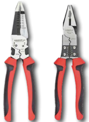
13 Abisolierzange Multi Gedore-Red Universal Abisolierzange zum Greifen, Abisolieren, Schneiden, Trennen und Crimpen. Trennen bis Gewinde M3,5, Crimpen 0,75 - 2,5mm². Ergonomischer 2-K Griff für ermüdungsfreies Arbeiten. Gesamtlänge 203mm. Best. Nr. H 131967 CHF 19,90
