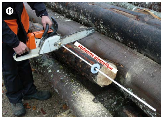
14 VarioMeter - Ablänghilfe Kein mühsames Anreißen! Stufenlos einstellbare Ablänghilfe von 10 bis 105 cm, robuster Fiberglas-Stab mit variablem Endteller, rasch und werkzeuglos kuppelbar, die Druckluftkupplung wird an den Adapterstecker an der Motorsäge gesteckt. Nicht bei Kettenschnellspannern und verliersicheren Muttern verwendbar. Adapterstück mit M 8 Innengewinde und 19mm Außen-6-kant. Best. Nr. H 28043 CHF 39,90
