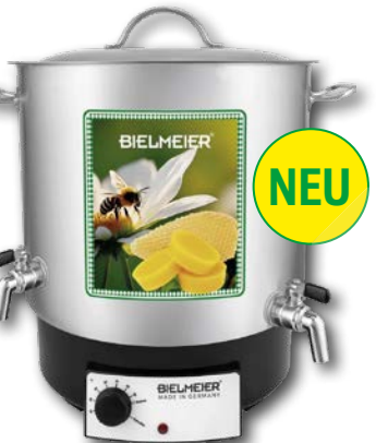
Wachsklärer Edelstahl 29 Liter mit Hahn 1/2" u. 3/4" Ideal zum Klären, Verflüssigen und Verarbeiten von Wachs sowie zum Einkochen und Warmhalten. Der Edelstahlkessel sorgt für zuverlässige Wärmeverteilung und vielseitige Einsatzmöglichkeiten. 29 Liter Volumen, 1800 Watt Leistung, Edelstahl-Auslaufhähne 1/2" und 3/4", Einlegetrost inklusive, 240 Volt. Best. Nr. H 134532 CHF 349,90 Frachtpauschale: 15,00
